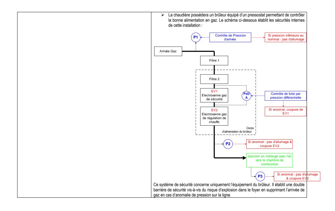
Un système de contrôle de la flamme non figuré sur ce schéma établit en outre une barrière vis-à-vis du risque de dysfonctionnement et de rejet de mélanges gazeux toxiques en arrêtant toute alimentation gaz dès lors que la flamme n'Induit pas la couleur, donc la température requise.
